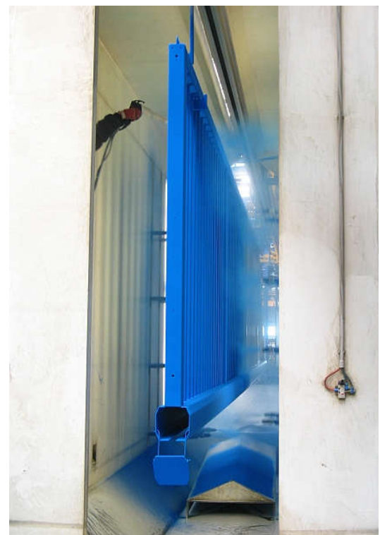
Applikation der Pulverdeckbeschichtung
